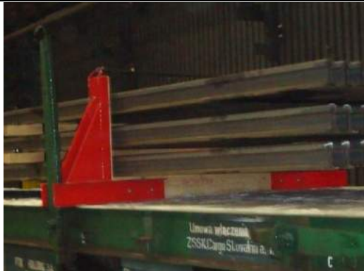
Telaio posizionato sul carro
